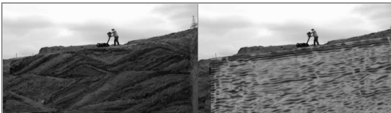
Фиг. 5. Изглед (фотография) към южния участък от изследваната площ по време на проучвателните работи с ясно изразен пласторед (горе) и наложен образ на част от радарграмата по Профил 1 (долу)
