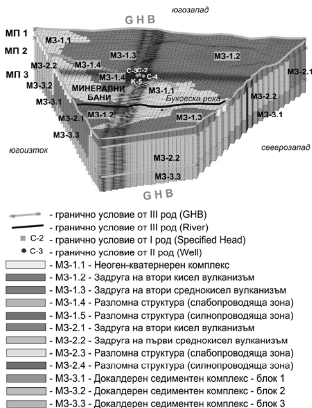
Фиг. 2. Геометрия на моделните пластове и зони. Гранични условия.
