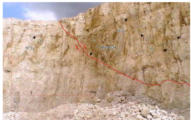
Фиг. 4. Разсед с вертикална амплитуда 1m в източния борт на хор. 135, т. 329
