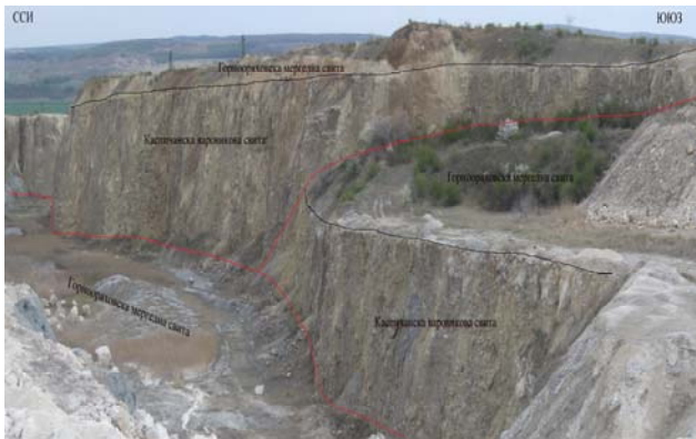
Фиг. 2 Фотопанорама на грабена в югоизточната част на кариера „Люляката“ с геоложка интерпретация.
