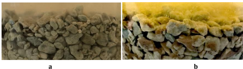
Фиг. 43. Зеолит – (a) в началото и (b) в края на експеримента.
