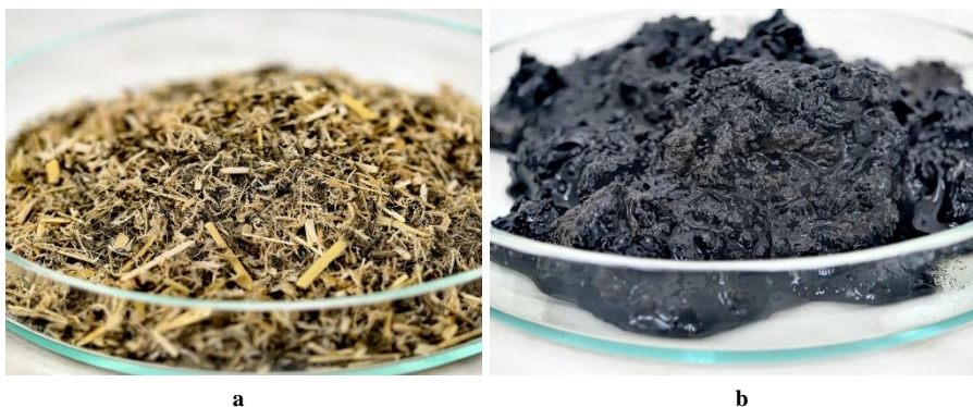
Фиг. 28. Изглед на субстрат от лабораторната инсталация за анаеробно пасивно/семипасивно третиране. a – преди експлоатация; b – след експлоатация;
