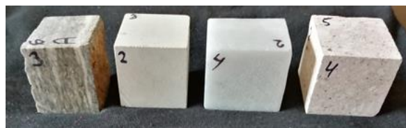
Фиг 1. Анализирани пробни тела; от ляво на дясно: гнайс, варовик, мрамор, зеолитизиран туф.
