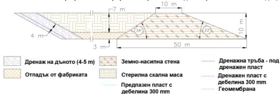
Фиг. 6. Схематичен профил на интегрирано съоръжение за депониране на минни отпадъци
