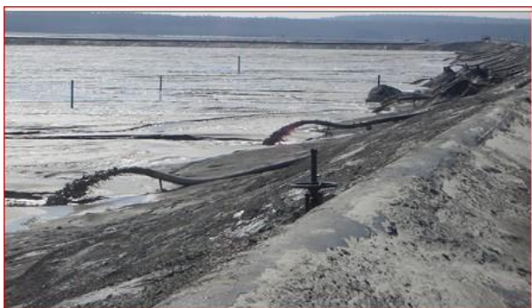
Фиг. 5. Субаерално депониране на отпадък чрез разпределителен тръбопровод в конвенционално отпадъкохранилище ( https://www.tailings.info/basics/tailings.htm )
