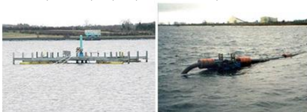
Фиг. 4. Подводно депониране на отпадък в конвенционално отпадъкохранилище ( https://www.tailings.info/disposal/deposition.htm )
