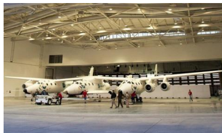
Фиг. 2. Самолетът и совалката, предназначени за изстрелване в около земна орбита. Тук огромното и скъпо съоръжение за изстрелване е заменено от обикновен хангар и самолетна писта.
