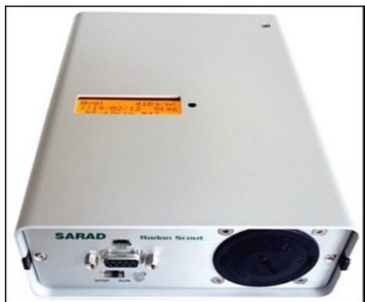
Fig. 6. The Radon Scout PLUS radiometer
