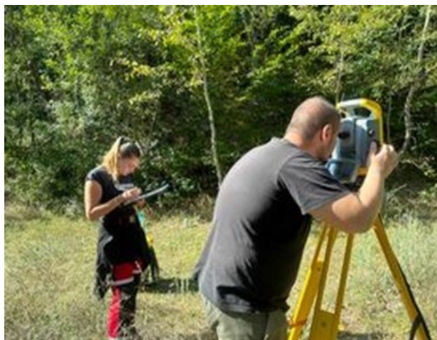
Фиг. 3. Извършване на ъглово-дължинни измервания
