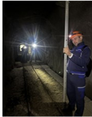
Фиг. 8. Извършване на геометрична нивелация
