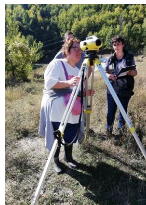
Фиг. 5. Извършване на геометрична нивелация
