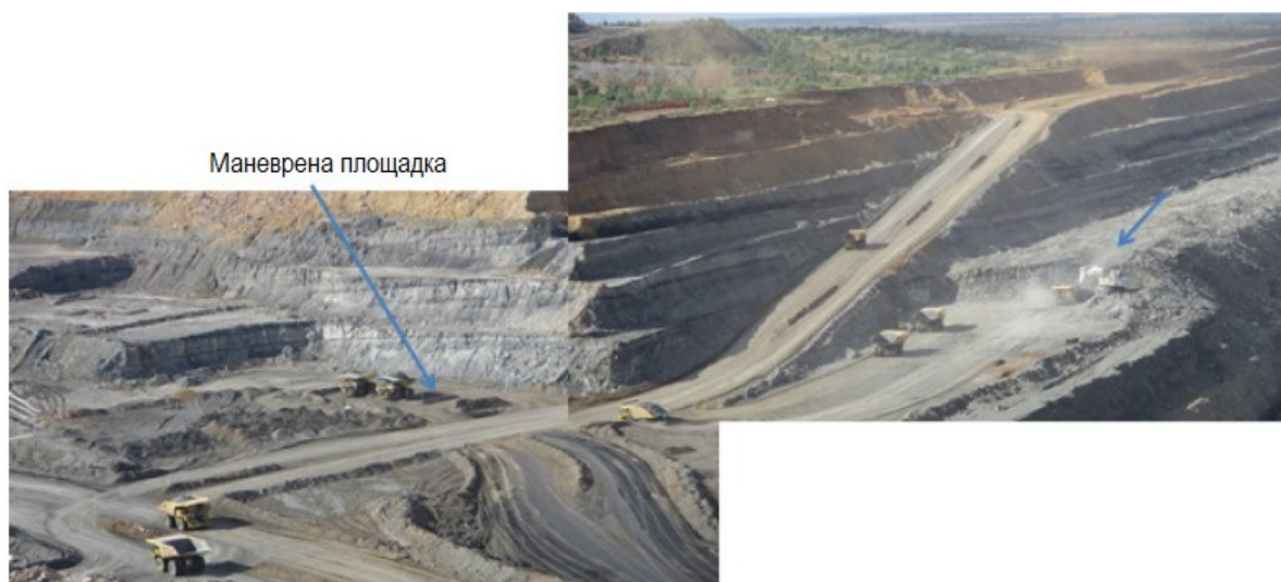
Снимка 1.1 Общ вид на транспортна схема в открит рудник
