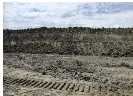
Снимка 1.5 Рудничен път с пластични деформации
