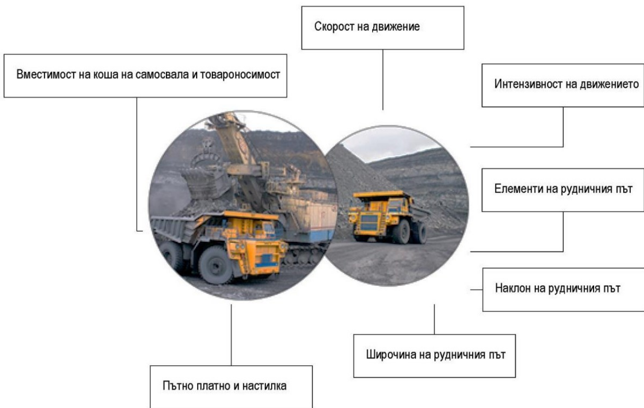
Фигура 2.1. Основните параметри, свързани с рудничните пътища при използването на автотранспорт в открити рудници
