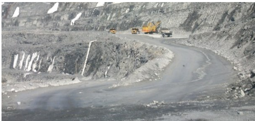
Снимка 1.3 Рудничен път с неправилен профил, предизвикващ пропадания
