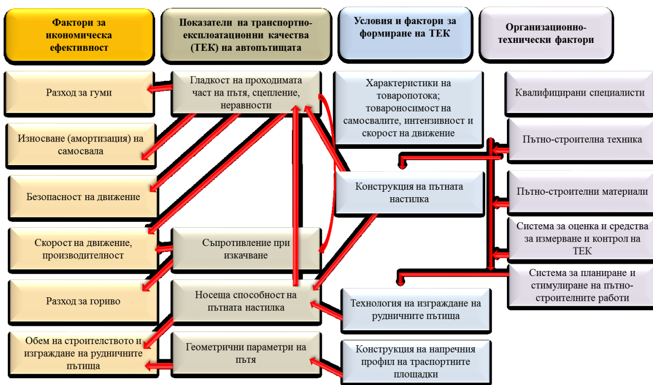
Фигура 1.1 Структура и взаимно свързани фактори, определящи пътните условия и ефективността на рудничния автотранспорт
