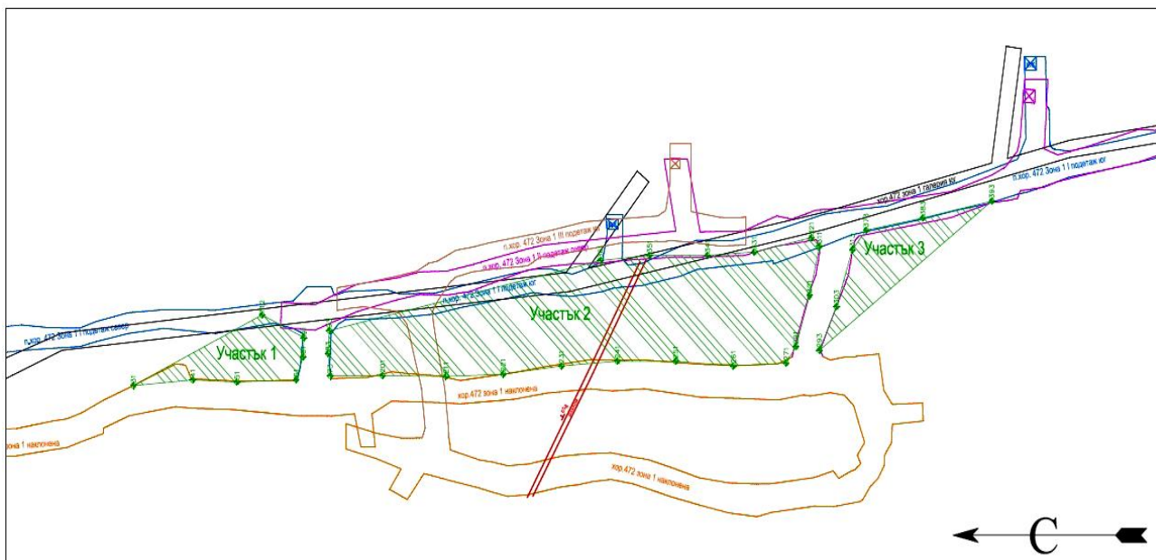
Фиг. VI.16. Ситуация в план с изобразени изследваните участъци от масива около минните изработки (защриховани в зелен цвят) и главния структурен разлом, пресичащ участък 2 (в червен цвят) [58]
