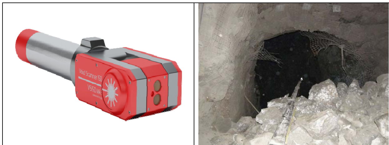
Фиг.IV.33. Void Scanner 150 (VS150) Mk3 – общ вид и в процес на работа
