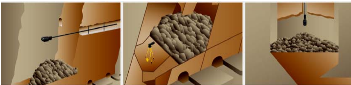
Фиг.IV.32. Cavity Monitoring System – сканиране в различни участъци
