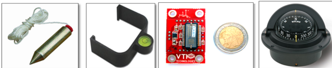
Фиг. III.18. Датчици за ориентиране: отляво надясно – отвес, либела, акселерометър, компас.
