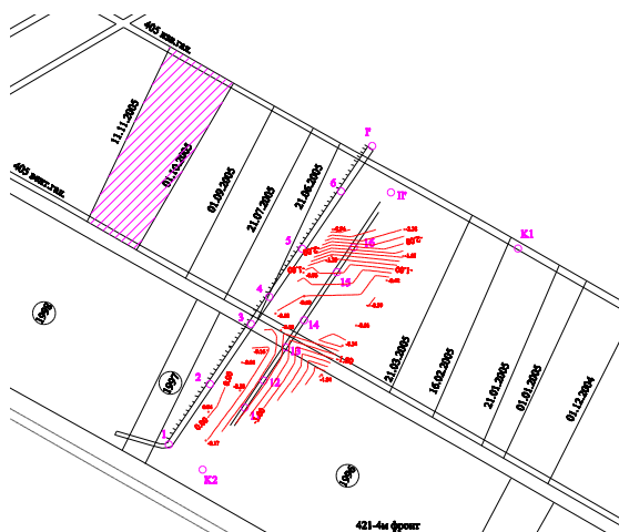
фиг.IV.4. Стойности и изолинии на главните деформации – ( E_2 \cdot 10^{-3} )
