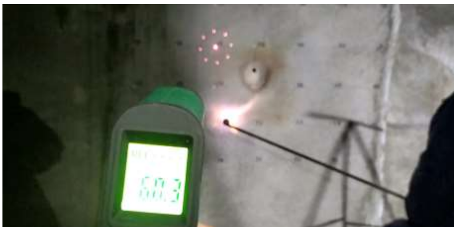
Фиг. 7.9: Разграфена експериментална повърхност и начин на следене на температурата на облицовката
