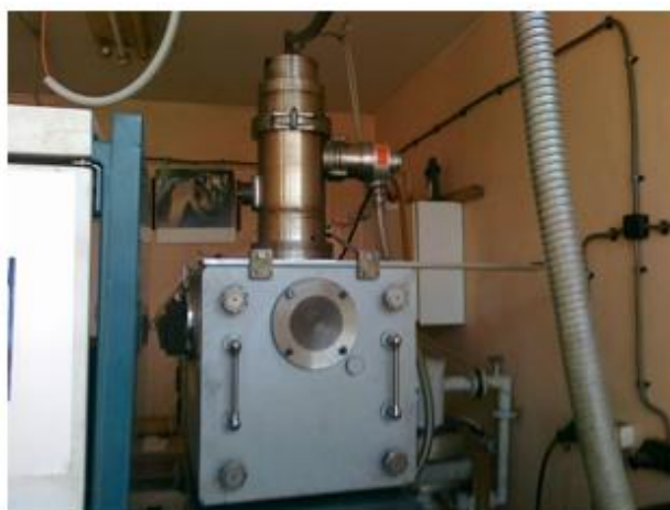
Фиг. 4.1. Инсталация за електроннолъчево заваряване, изпарение и повърхностна модификация
