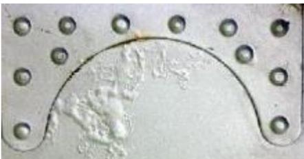
Fig. 16. Filiform corrosion
