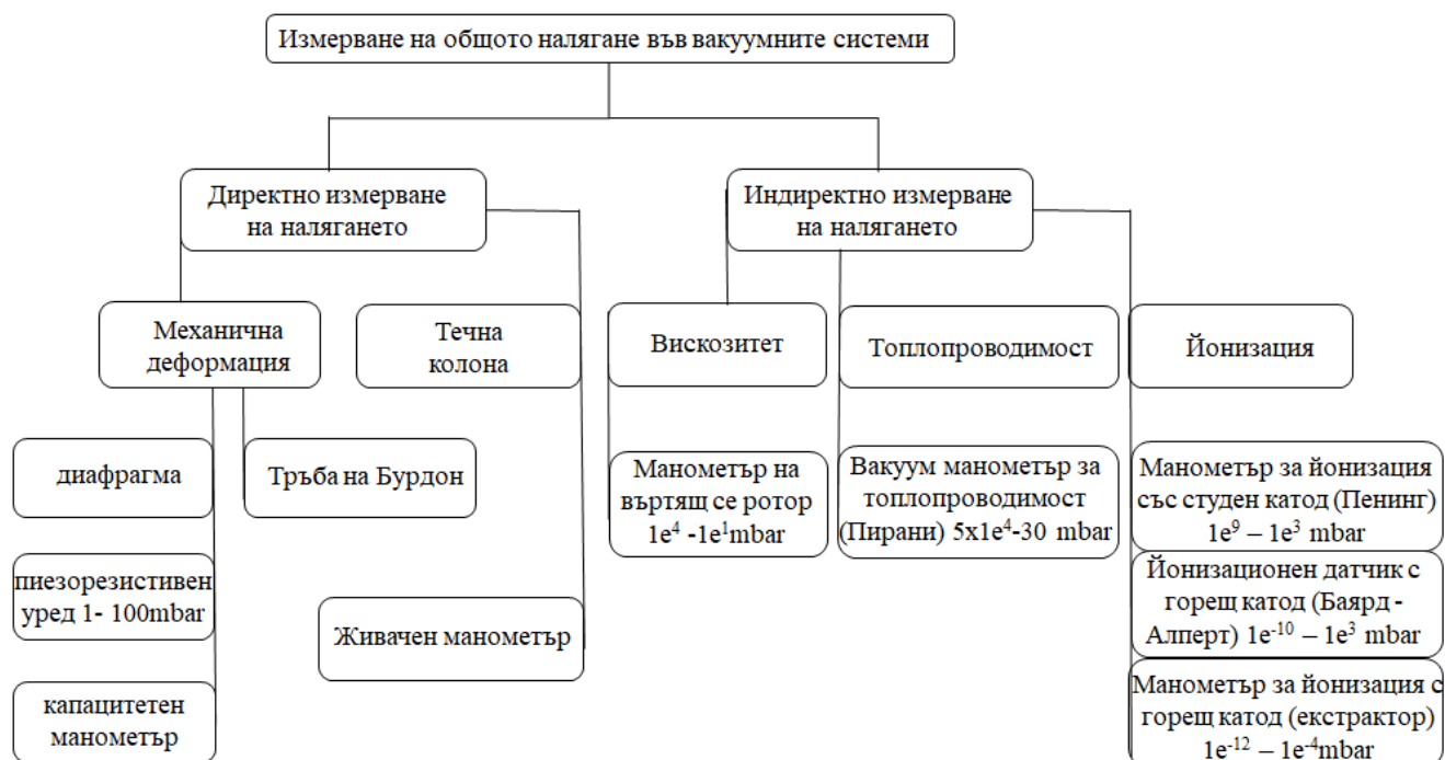
Фиг. 3.12. Измерване на общото налягане във вакуумните системи
