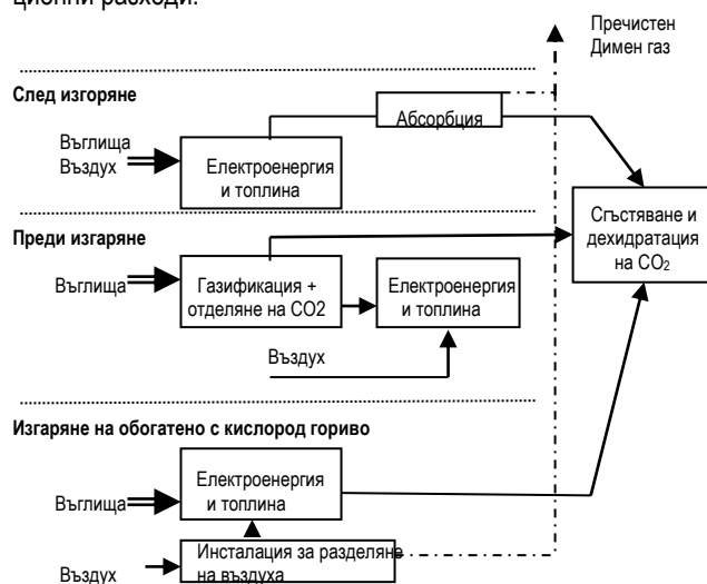
Фиг.6. Технологии за улавяне на CO 2 в ТЕЦ (адаптирана по ZEP, 2006)
