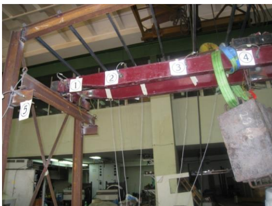
Фиг.2. Разположение на акселерометрите за измерване на динамичното поведение на главна греда в хоризонтално направление- схема и общ вид
