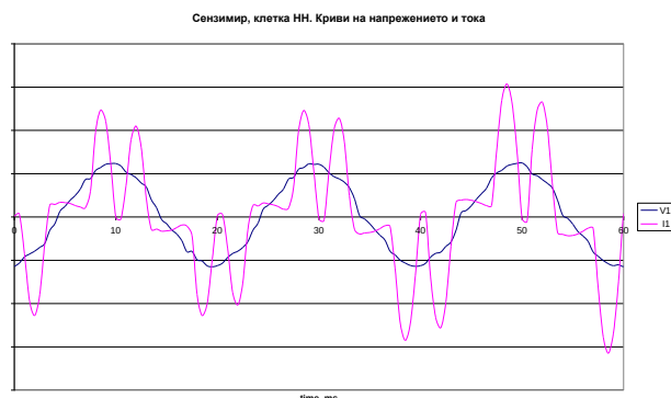
фиг.3. Крива на напрежението и тока на стан Sendzimir
