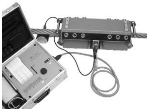
Фиг. 4. Съвременен магнитен дефектоскоп
