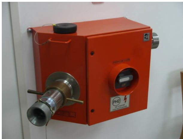
Фиг. 9. Автоматичен прекъсвач с щепселно съединение за захранване на пробивна карета.
