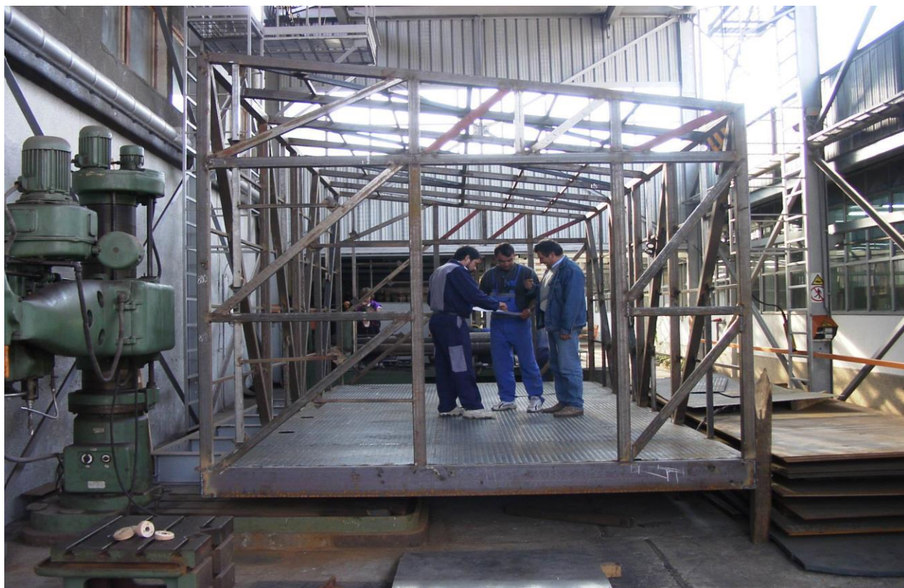
Фиг. 2. Конструкция (Скелет) на комплектна преносима ел. уредба
