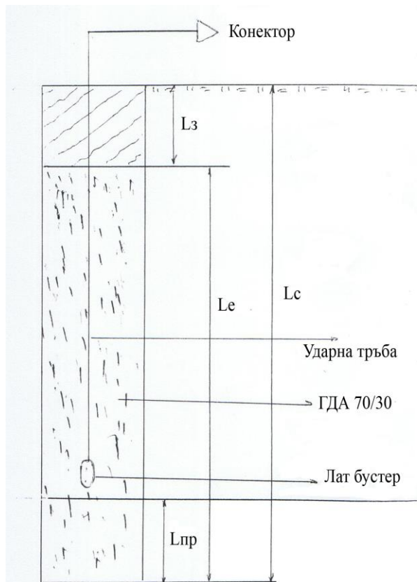
Фиг.1 Типова конструкция на заряда в кариера „Клокотница“ L забивка - 2 m; L преудълбаване - 0,3-0,5m; L сондаж - 10,65 m; L експлозив - 8,65 m
