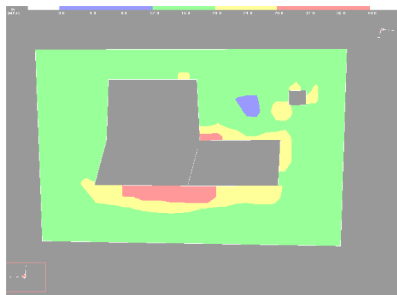
Фиг. 8. Стойности на максимални главни напрежения по разрезна равнина №2
