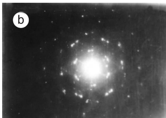
Фиг. 3. Електронोगрами на рансиеит (а) и рансиеит-тодорикитови агрегати (б) от находище Кремиковци
