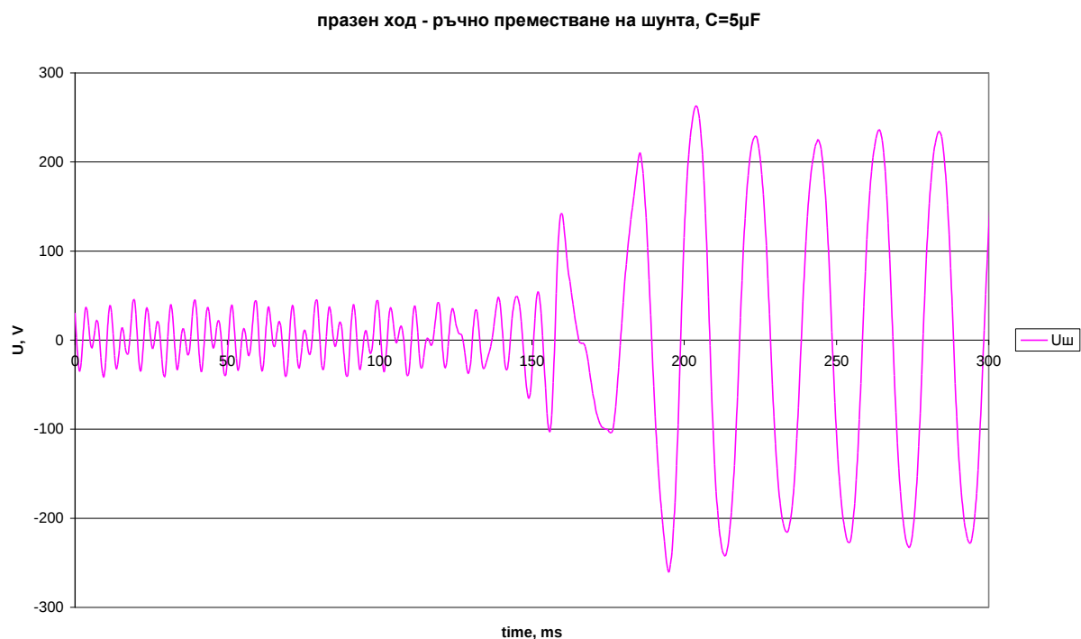
Фиг. 4.12. Изменение на напрежението в шунтовата намотка при ръчно преместване на шунта
