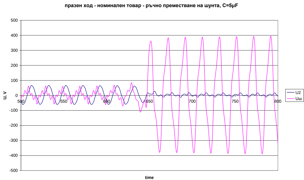
Фиг. 4.16. Изменение на напрежението във вторичната и шунтовата намотки при номинален товар и ръчно преместване на шунта
