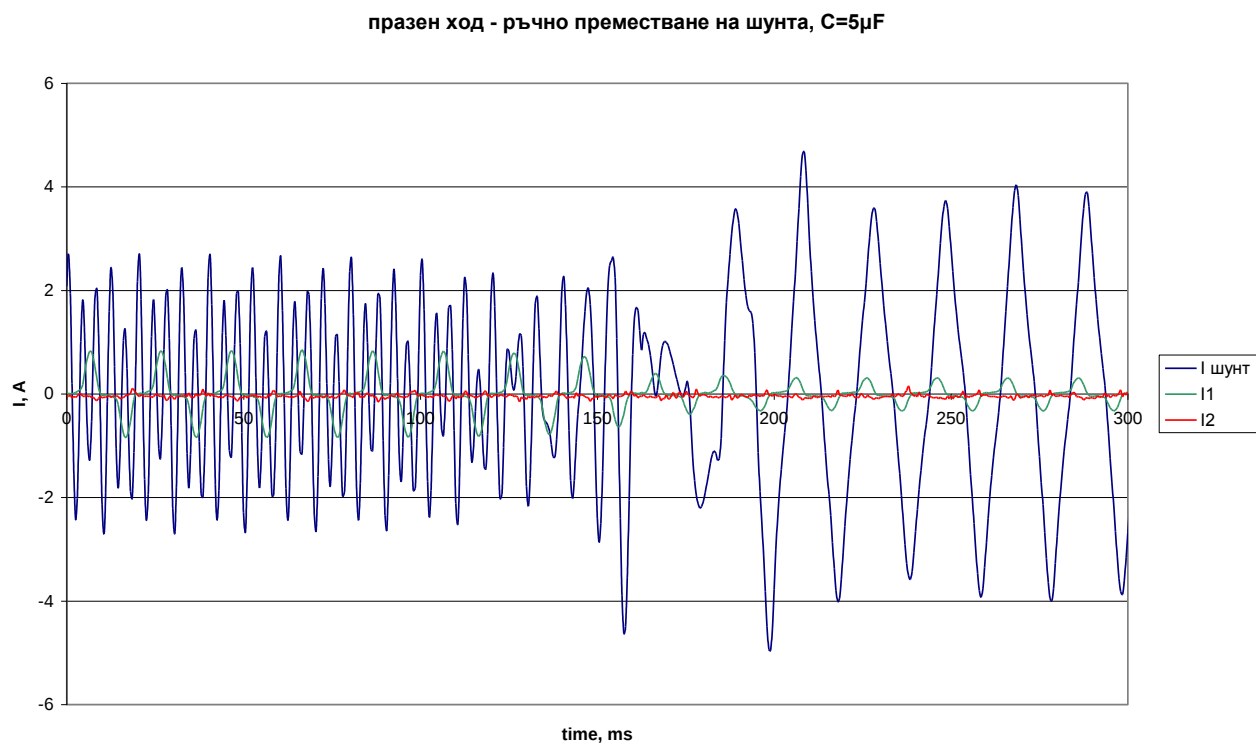
Фиг. 4.13. Изменение на токовете в първичната и шунтовата намотки при ръчно преместване на шунта
