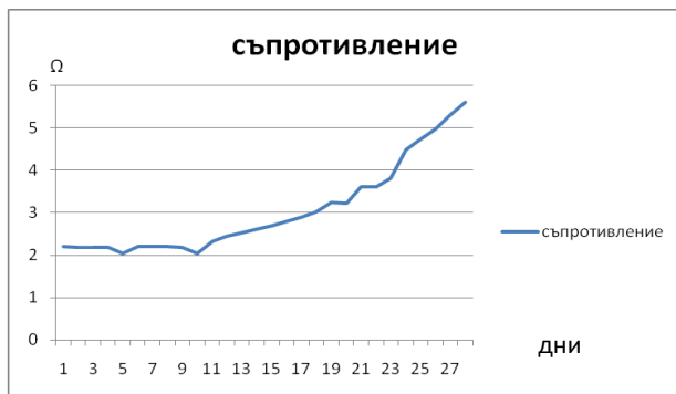
Фиг. V. 15 промяна на съпротивлението при волтамперометрията
