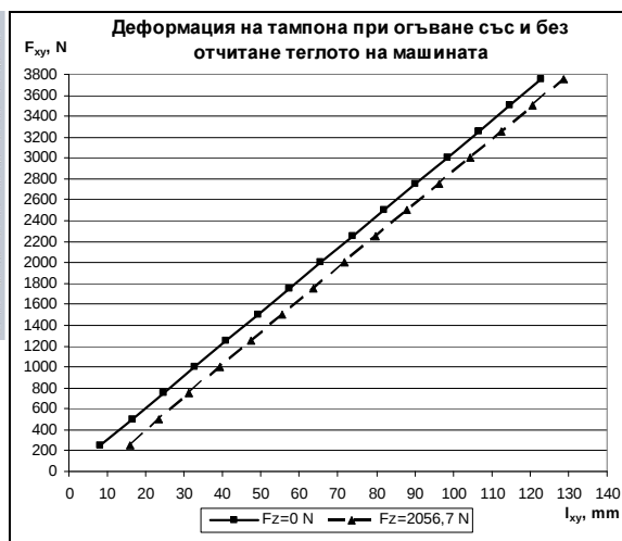
Фигура 3.50. Симулационни характеристики на деформацията на тампона в равнината xy
