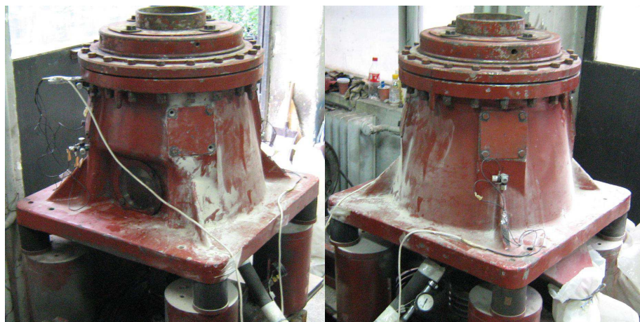
Фигура 5.13. а) Разположение на акселерометрите върху КИД-300 при измерване на принудени трептения
