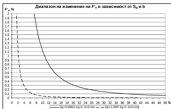
Фигура 5.4. Диапазон на изменение на дяла на силата създавана от вътрешния конус, представен в относителни единици (в проценти от общата сила на трошене)
