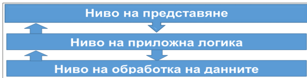
Фиг. 3.5. Трислоен модел на клиент-сървър информационна система.
