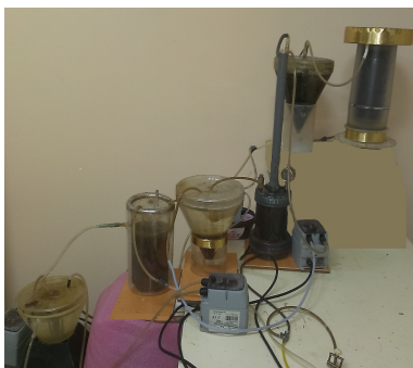
Фигура 2. Лабораторна инсталация - Вариант I за третиране отпадъчни води, включваща денитрифициращ реактор (ДН), и два аеробни реактора за нитрификация
