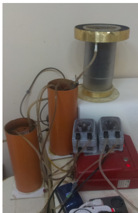
Фигура 12. Модифицирана лабораторна инсталация - Варианти III за третиране отпадъчни води, с предварителна денитрификация и два последователно свързани реактора с периодично действие
