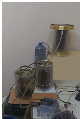
Фигура 4. Модифицирана технологична схема на Лабораторна инсталация - Варианти II, с предварителна денитрификация и два последователно свързани реактора с периодично действие
