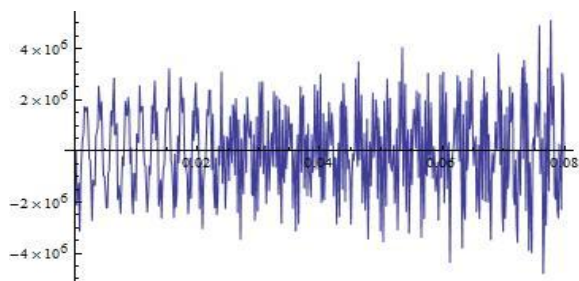
Фиг. 3. Диаграма на напрежението \sigma /по ординатната ос/ при дължина на инструмента x /по абсисната ос/ 1291 mm с твърдосплавна пластина 17 mm при три удара
