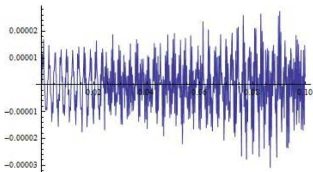
Фиг. 9. Диаграма на отместването \varepsilon /по ординатната ос/ в граничната точка при дължина x /по абсисната ос/ на инструмента 1291 mm с твърдосплавна пластина 17 mm при четири удара
