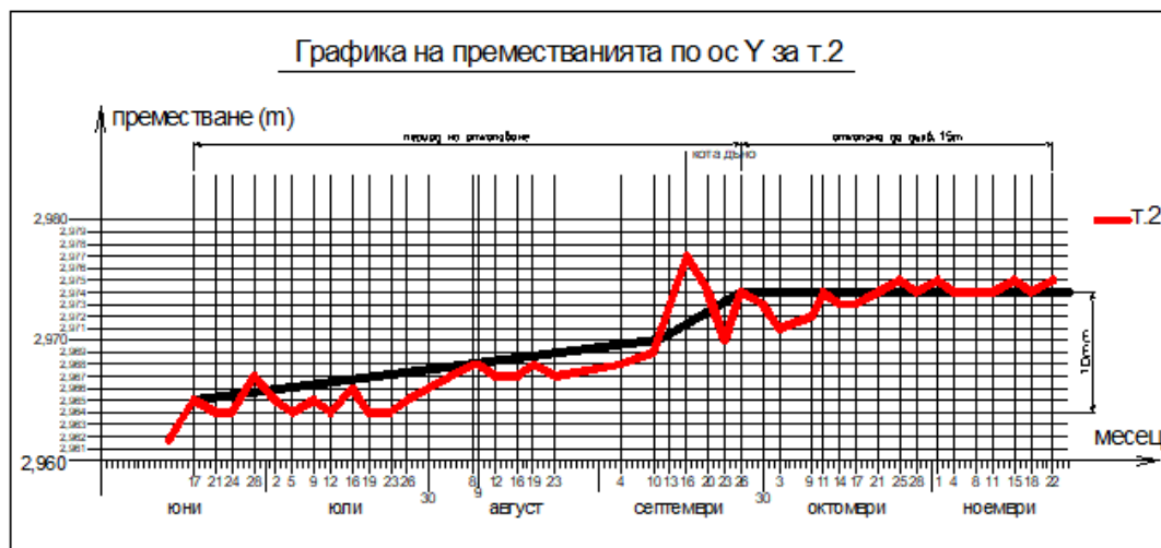
Фиг. 2.13.а – Диаграми на измерените премествания на ръба на изкопа, в близост до училището
