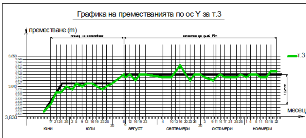
Фиг. 2.13.б - Диаграми на измерените премествания на ръба на изкопа, в близост до училището
