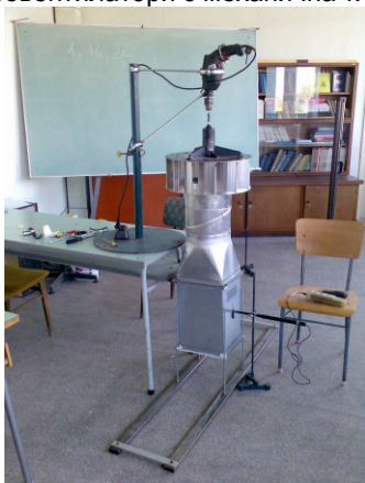
Фигура 3.9 Стенд № 3 (1- електродвигател с променливи обороти, 2 – термоанемометър, 3 ветровентилатор)
