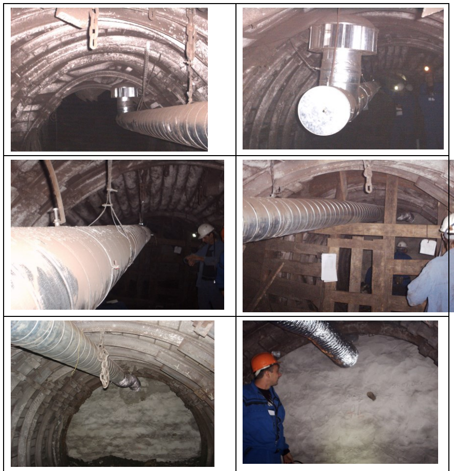
Фигура 5.9 Вентилационната система за местно проветряване с Н-225 в рудник "Миньор"
