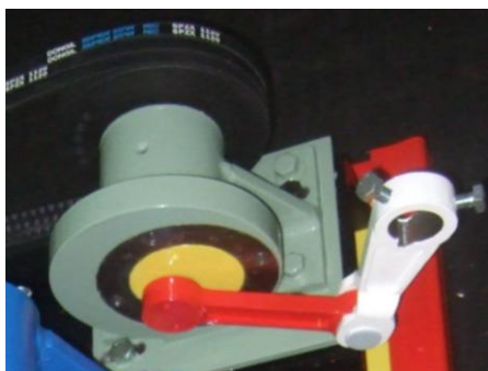
Фиг. 91 Шарнирен четиризвене механизъм
