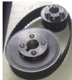
Фиг. 90 Зъбноремъчна предавка, трансформираща въртливо движение от КТМ към изпитвания вал
