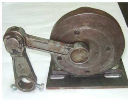
Фиг. 91 Шарнирен четиризвене механизъм
