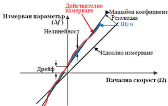
Фигура 10. Параметри на грешките, обуславящи разликата между идеално и действително измерване
