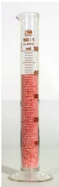
Фиг.4.15. Сравнително изследване на попиващата способност на САС: а) - смесена с 5,5% емулсия; в) - смесена с 5,5% дизелово гориво
