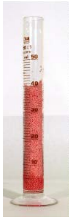
Фиг.4.15. Сравнително изследване на попиващата способност на САС: а) - смесена с 5,5% емулсия; в) - смесена с 5,5% дизелово гориво
