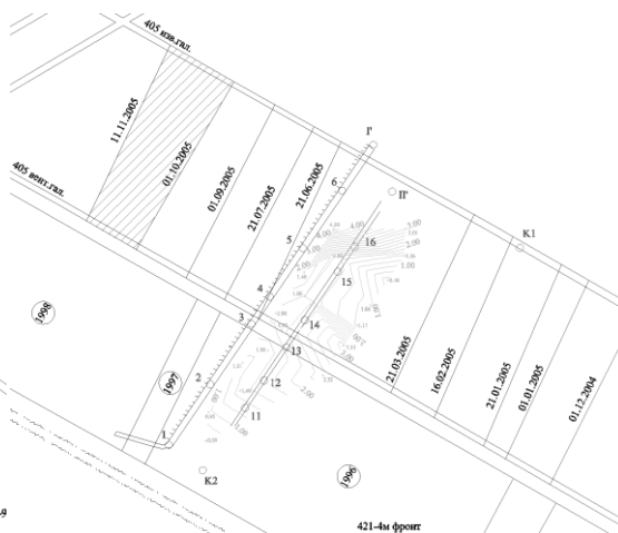
фиг.IV.6. Стойности и изолинии на интензивността на формоизменение на трците (максимално преместване – \gamma_m \cdot 10^{-3} )
