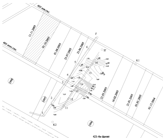
фиг.IV.3. Стойности и изолинии на главните деформации – ( E_1 \cdot 10^{-3} )
