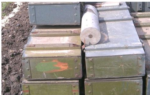
Фиг.2. Неправилно съхранение на отпадъчни бойни припаси.
