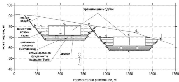
Фиг. 3. Вертикален разрез на хранилищните модули
