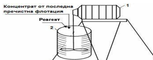
Фиг. 1. Лабораторна апаратура за разрушаване на пяната: 1 – двигател с бъркалка; 2 – градуиран мерителен цилиндър
