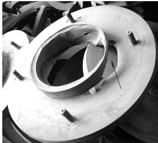
Фиг. 5. Добре изразено хидроабразивно износване на бронираны тяло (горе) и плоча предна (долу) на центробежна едностъпална помпа.
