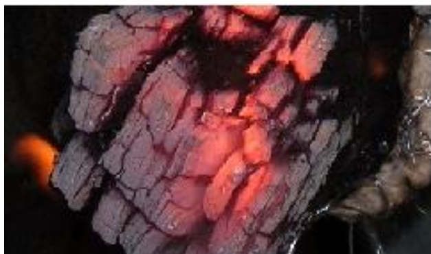
Фиг.2. Внешний вид торца образца подмосковного бурого угля, подвергавшегося процессу горения
