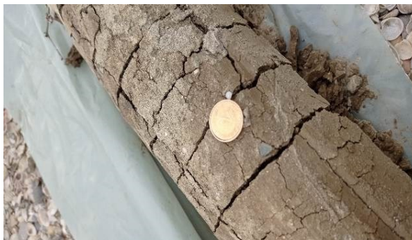
Фиг. 6. Уплътнена глина от сондаж С-2301, метър 14. В глината се разпознават късове от горнокредни вулканити и кварцови жили.
