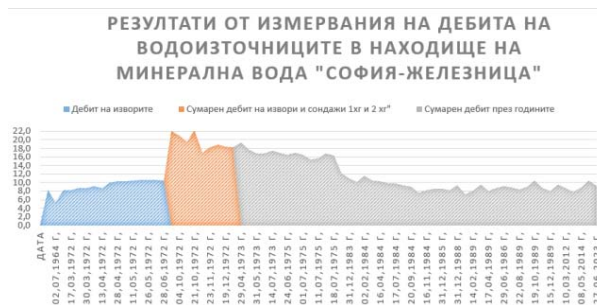
Фиг. 4. Изменение на дебита на водоизточниците от находище на минерална вода „Железница“
