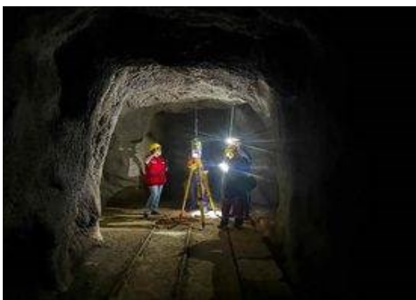
Фиг. 9. Заснемане на контурите на избран участък от минна изработка
