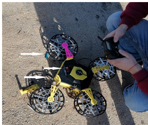
Фиг. 7. Състояние на дрона след падане от 10 метра
