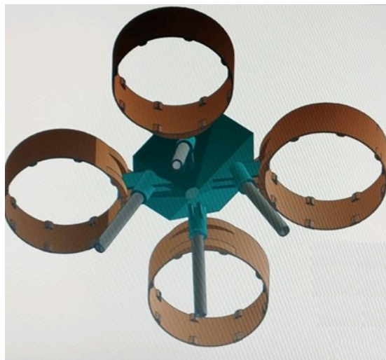
Фиг. 3. Конструкция на тялото на дрона
