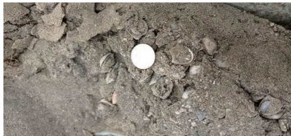
Фиг. 5. Черупки в сондажна ядка от сондаж С-2302. Поради факта, че теренът е пясъчен и слабо споен след изваждане на повърхността ядката много бързо се разпада.
