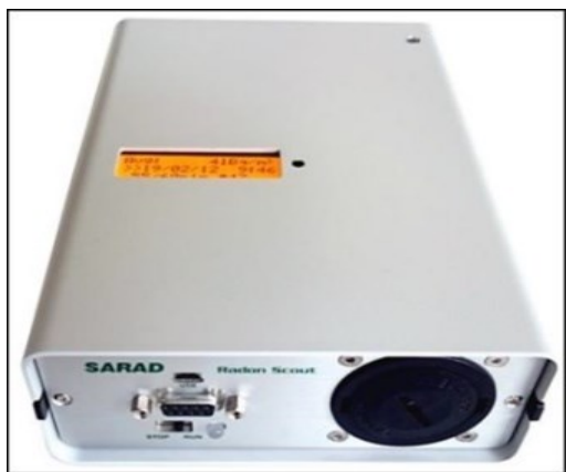
Fig. 6. The Radon Scout PLUS radiometer
