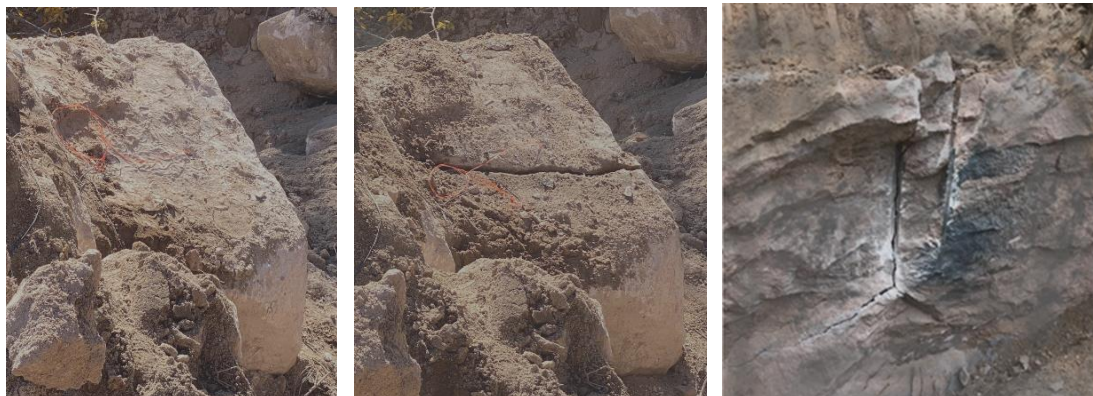
Фиг. 3.9. Отцепване на скален блок чрез метало-съдържащи пиротехнически смеси
