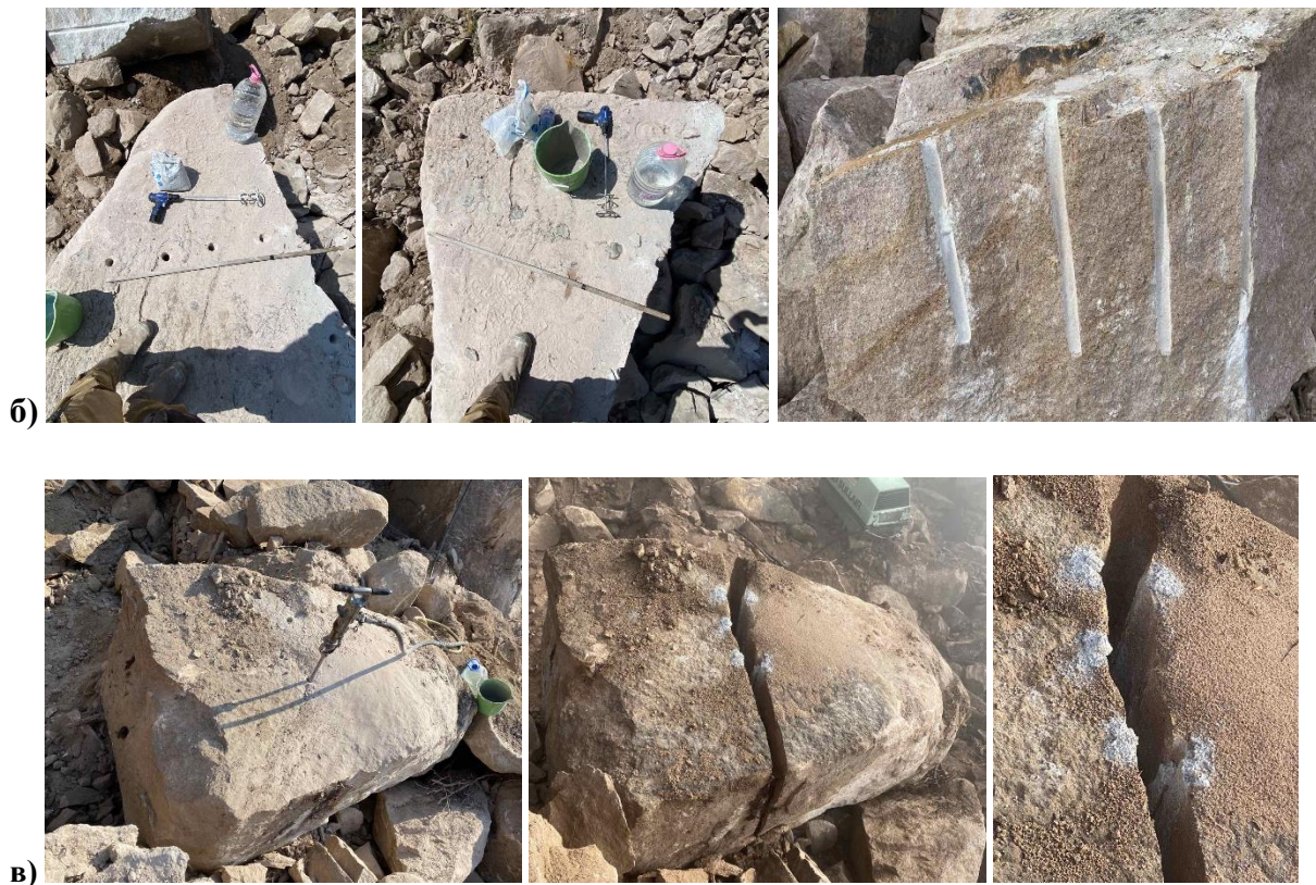
Фиг. 3.2. Разцепване на скален блок чрез експандиращи химични смеси на кариера „Казаните - 1“; а) Тест - 1; б) Тест - 2; в) Тест - 3
