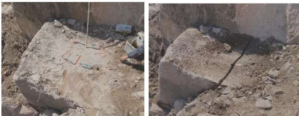
Фиг. 3.19. Експериментално отцепване на скален блок от масива със заряди от отпадъчни барути
