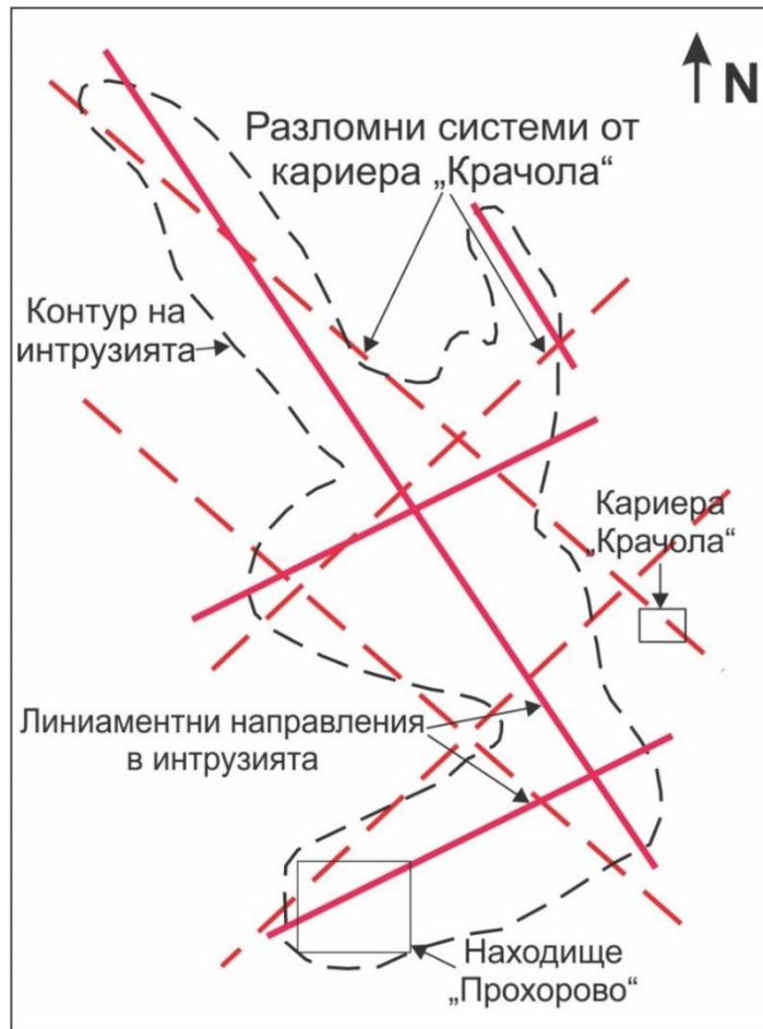
Фигура 10.3. Фигура с наложени върху очертаванията на кварц-диоритовата интрузия от фиг. 10.1. а) разломните системи установени в кариера „Крачола“ (с червени пунктирани линии), линиаментните направления, които интрузията формира (червени непрекъснати линии) и местоположенията на находище „Прохорово“ и на кариера „Крачола“ в която са проведени изследванията.
