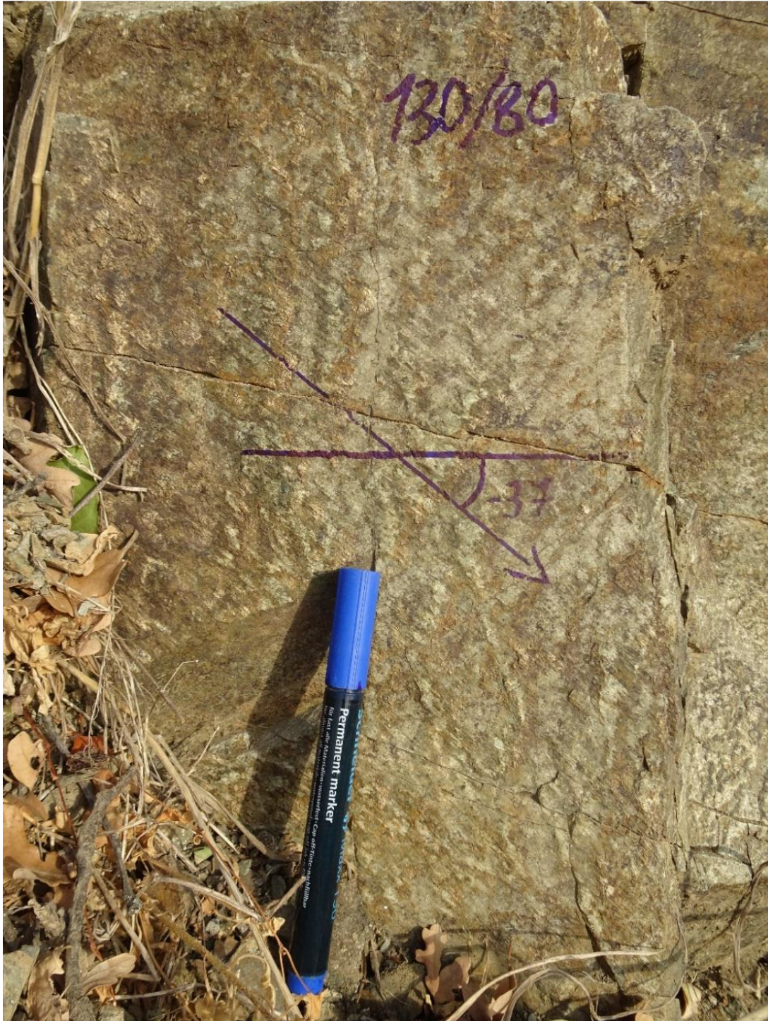
Фигура 8.9. Фотография на разломна стена с посока и наклон съответно 130^\circ и 80^\circ . Направлението на преместването по нея склучва ъгъл с хоризонтала -37^\circ по конвенцията на Аки-Ричардс (Аки, Richards, 1980) (сн. Д. Страхилев).
