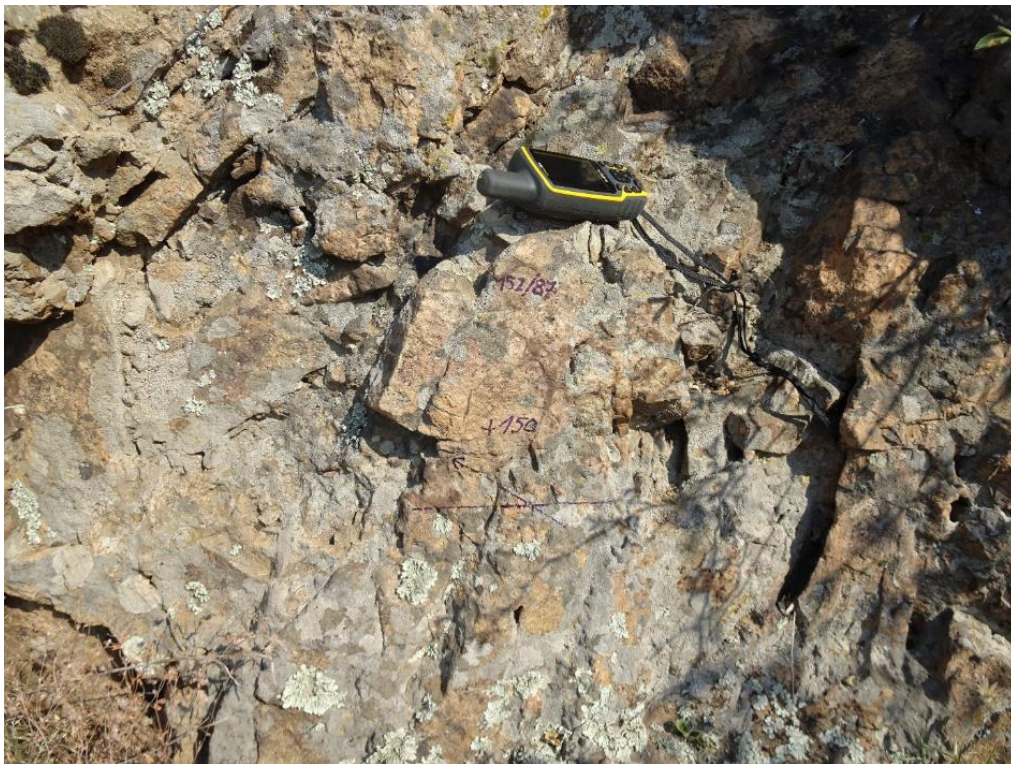
Фигура 9.5. Измерване на посоката на разломна повърхност и посоката на преместване по нея в съответствие с конвенцията на Аки-Ричардс (сн. Д. Страхилев).
