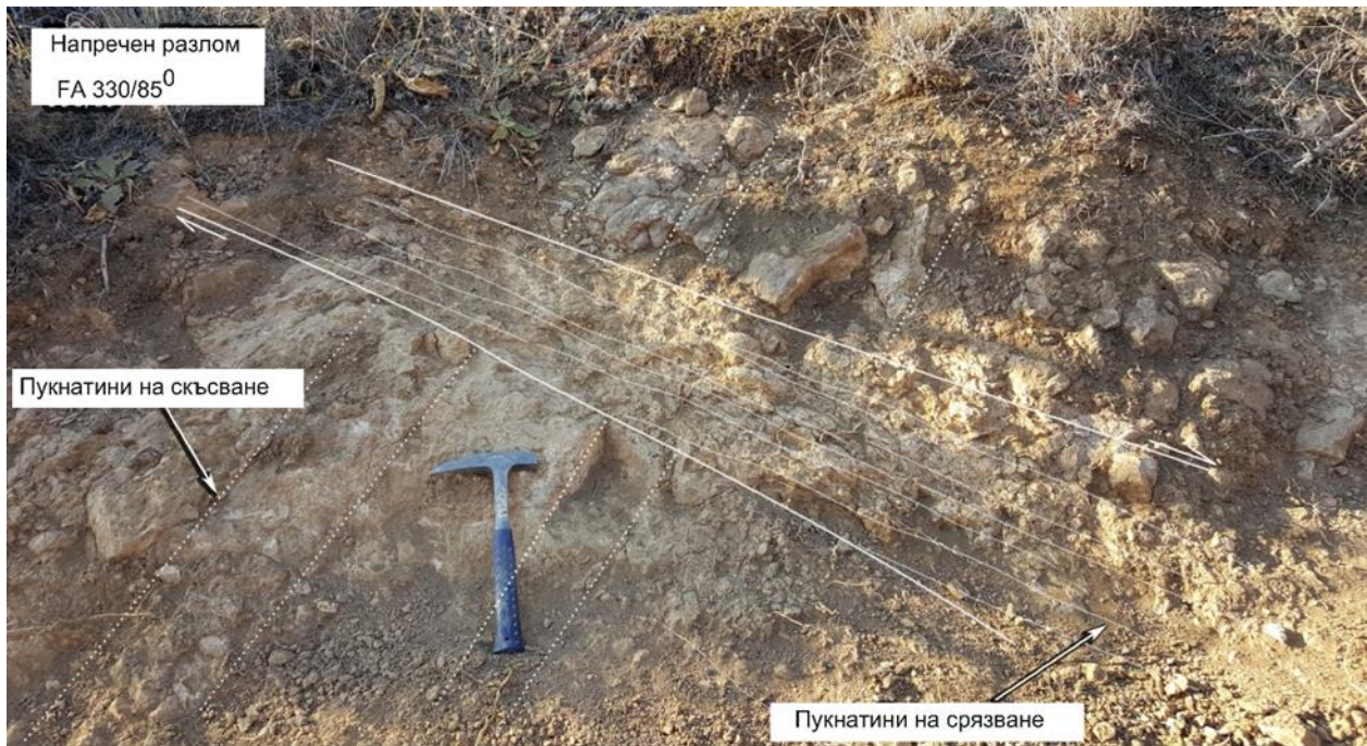
Фиг. 3.17. Снимка на разкрития на косо разположени СЗ-ЮИ разломи (сн. Ив. Маринов)
