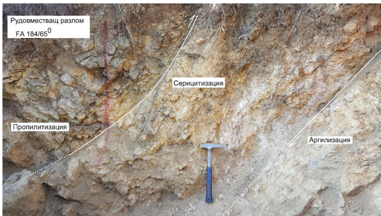
Фиг. 3.16. Снимка на разкрития на изток-западни рудовместващи разломи, с посока на затъване на юг (сн. Ив. Маринов)
