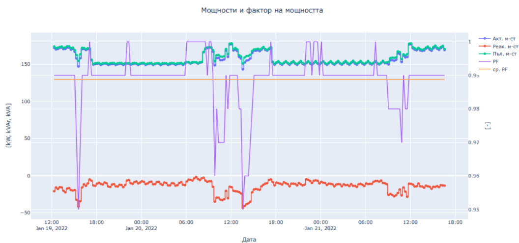
Графика 4.4 Изменение на активната, реактивната и пълната мощност и фактора на мощността PF
