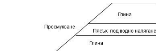
Фиг.1.5: Ерозия вследствие просмукуване
