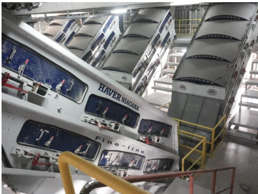
Рис. 7. Грохота тонкой класификации „HAVER-FINE-LINE HD 1850 x 3750“
