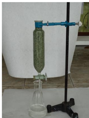
Фиг.2. Процеса на филтрация през зеолитова колона
