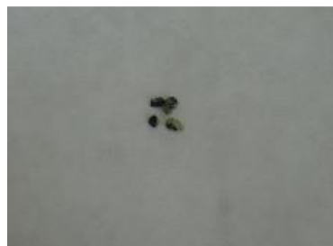
Фиг.3. Зеолитни зърна адсорбирали на повърхността си нефтепродукти
