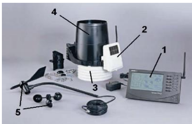
Фиг. 5. Метеорологична станция Vantage Pro 2
