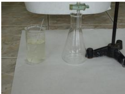
Фиг.1. Сондажна вода, след протичане на процеса хидролиза, следствие реакцията с Al 2 (SO 4 ) 3
