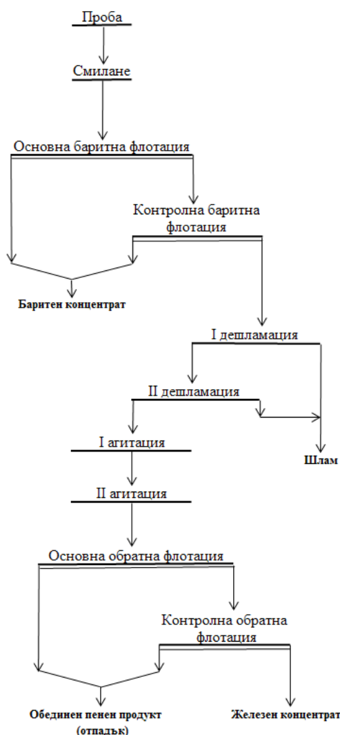
Фиг. 1. Схема на флотация на некондиционния железен материал
