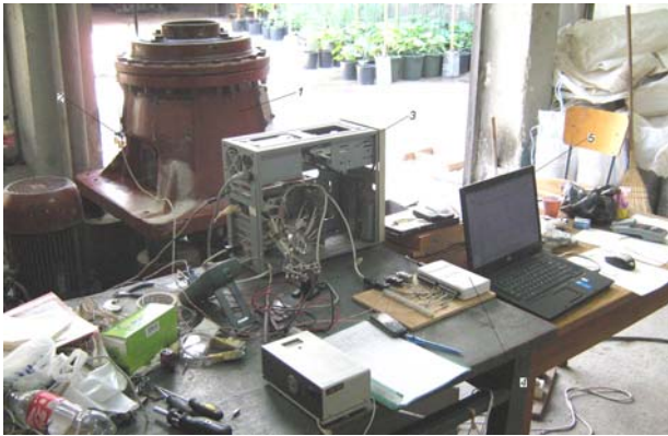
Фиг. 5. Измервателна уредба на вибропараметри 1 – КИД-300; 2 – акселерометри; 3 – захранващ блок; 4 – АЦП; 5 – преносим компютър
