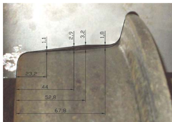
Фиг. 4 Износване на бандажна гривна рудник „Марзян” локомотив РКП-10 7500 км
