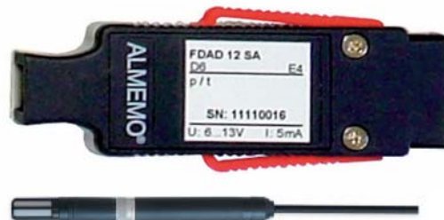
Фиг. 2. Комбиниран сензор за температура, налягане и относителна влажност
